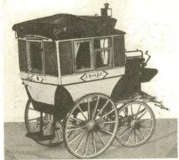
Postomnibus der Kgl. Württ. Post, wie er um 1850 zwischen Ebingen und Balingen verkehrte. Die Fahrgäste saßen quer zur Fahrtrichtung; aus diesem Grunde befindet sich auch die Einsteigtür an der hinteren Wagenseite. Der Wagen ist bereits mit einer Hinterradbremse und einem verbesserten Fahrerbock ausgestattet.
