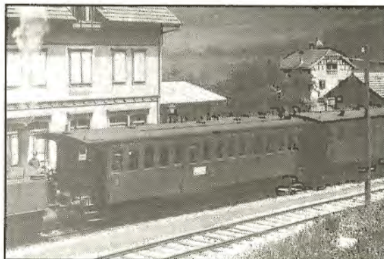
Vierachsiger Durchgangswagen 3. Klasse Typ C mit 68 Sitzplätzen. Die Wagen wurden ab 1846 so gebaut. Sie hatten auch in der 3. Klasse schon Glasfenster (nicht bloß Ledervorhänge wie in anderen Bahngesellschaften). Drehgestelle machten sie kurvenfreundlicher. Die Personenzüge am 4. Juli 1878 mussten aus solchen „Intercommunicationswagen“ gebildet worden sein.
