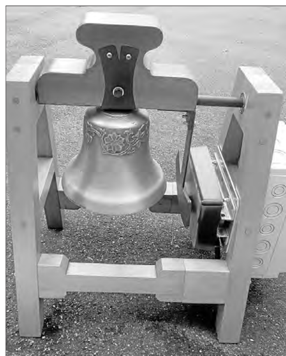
Simulations-Glockenstuhl mit berührungslosem Linearantrieb
